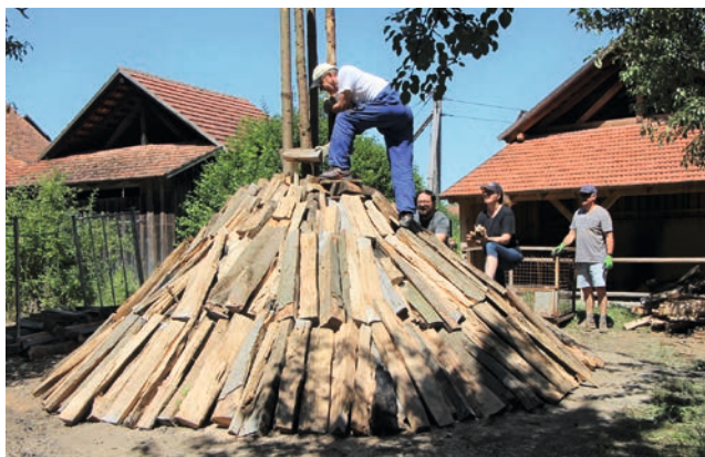
Schon das Aufschichten des Kohlemeilers rund um den Luftschacht ist eine Wissenschaft für sich. Foto: Ute Rauschenbach
